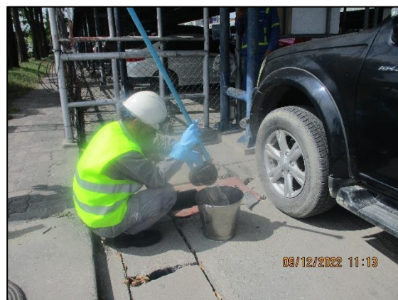
รูปที่ 3.2 การเก็บตัวอย่างคุณภาพน้ำทิ้งบริเวณจุดที่ 2 บ่อกักน้ำสุดท้ายหลังจากผ่านการบำบัดและ กำจัดไขมันของท่าเรือ B1 ก่อนถูกส่งไปยังระบบบำบัดน้ำเสียส่วนกลางของท่าเรือแหลมฉบังต่อไป
